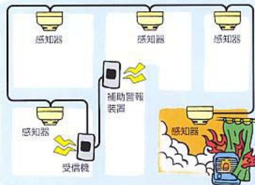
この他にも、警報を音声で知らせるタイプ、火災とガス漏れを両方検知できる複合タイプ、受信機と感知器の配線が不要な無線タイプなどがあります。
